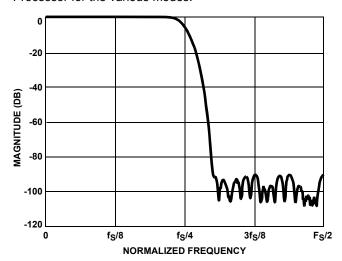
FIGURE 2. FREQUENCY RESPONSE OF 67-TAP HALFBAND FILTER
