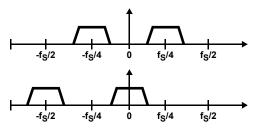
FIGURE 4. fs/4 NEGATIVE SHIFT: DOWN CONVERSION
