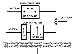
FIGURE 6. POLYPHASE IMPLEMENTATION OF DECIMATE BY 2 HALFBAND FILTER
