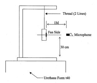
1 METER FROM MICROPHONE TO FAN INTAKE
